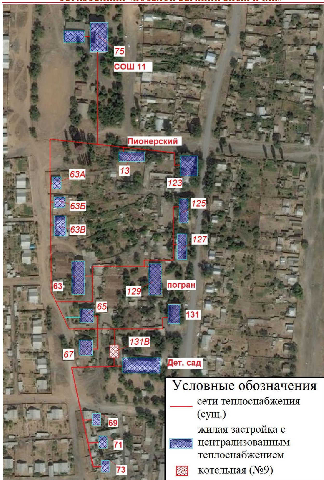
Рис. 15. Схема теплоснабжения Котельной № 9.
