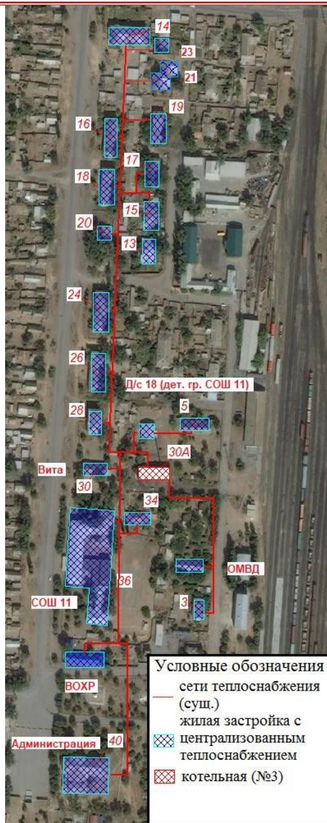
Рис. 14. Схема теплоснабжения Котельной № 3.
